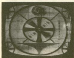
Fig. 3. Image estompée par le manque de réponse aux fréquences.
