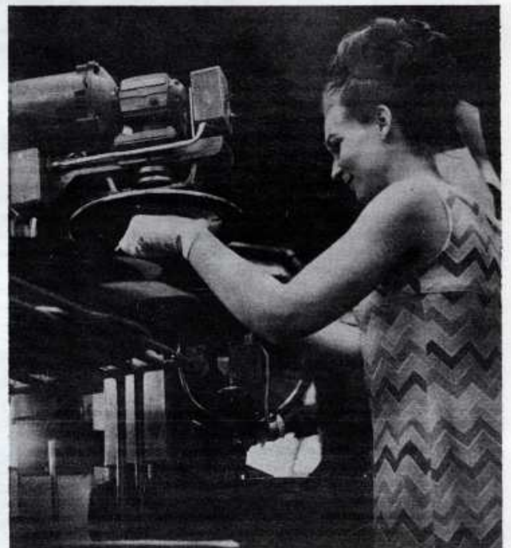
Prise à notre usine de Smiths Falls, cette photo nous fait voir Denise McLinton, alors qu'elle retire un disque rogné d'un appareil à bords, qui enlève le matériel en surplus afin de laisser une bordure nette.
