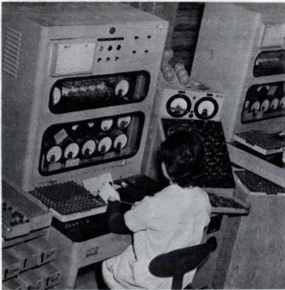
Une des habiles vérificatrices de lampes de Cowansville exécute sa besogne devant la console d'essais. Chaque lampe est vérifiée afin de chercher à déceler les déficiences possibles dans la continuité, le gaz, le courant lumineux et l'émission. La vérificatrice qu'on aperçoit sur cette photo est Thérèse Perreault.
